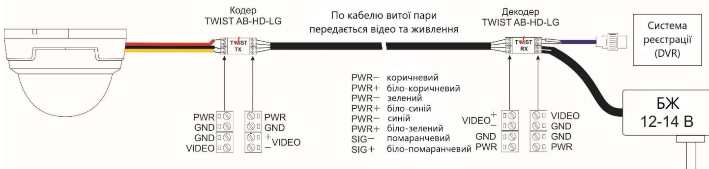
Мал.2 Схема підключення TWIST AB-HD-LG для передачі відеосигналу та живлення з боку DVR
