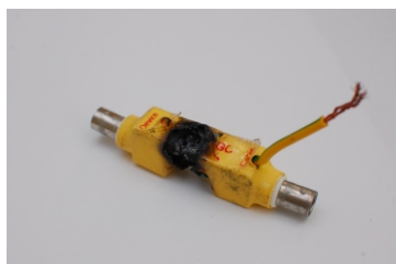
Рис. 6. Импульсы в линиях передачи, возникающие при грозах.
