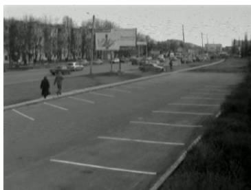
Рис. 16. Мелкие снежащие полосы – помехи от импульсных БП
