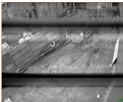
Рис. 8. Импульсные помехи коммутации нагрузок
