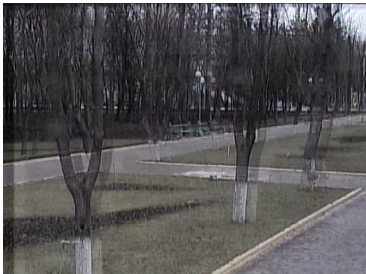
Рис. 17. Отражения в линии передачи видеосигнала
